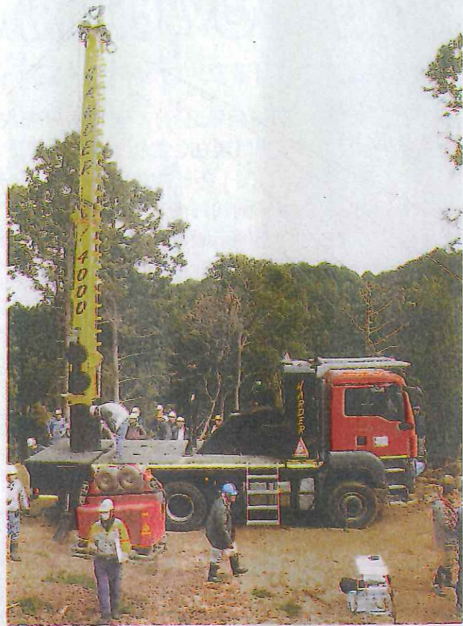
タワーヤーダを積載した大型6WDトラックを見学する参加者たち。10日、新宮市内の山林
