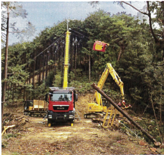
トラック搭載式高性能タワーヤードと自走式搬器を使った効率的な集材作業
