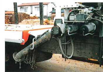
出し入れがスイッチ操作で可能なアウトリガ
